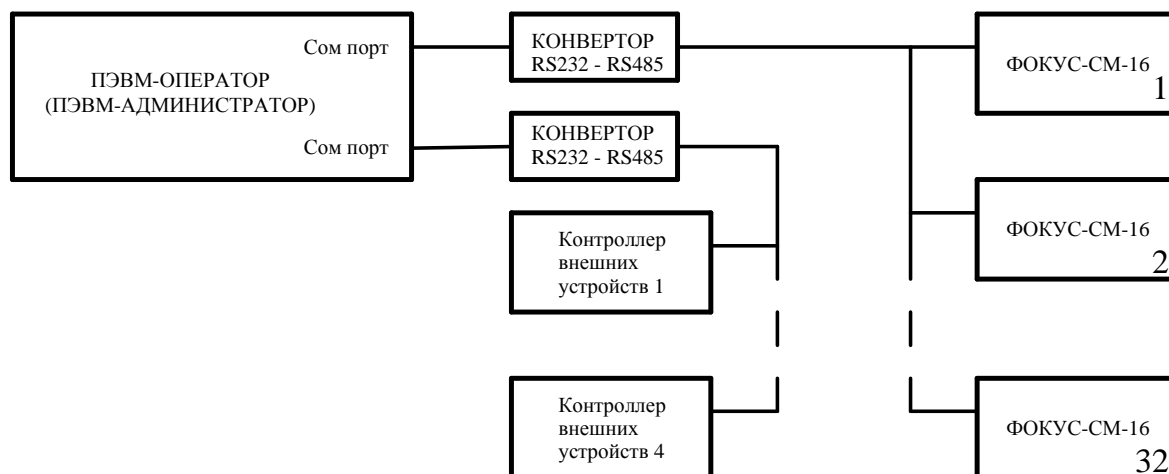
Рисунок 2.10 - Схема подключения Фокуса-СМ-16 и КВУ08 к «ПЭВМ-ОПЕРАТОР» или «ПЭВМ-АДМИНИСТРАТОР»
