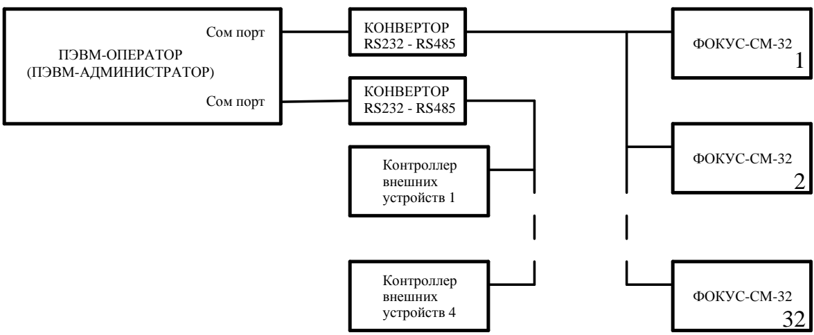
Рисунок 2.13 - Схема подключения Фокуса-СМ-32 и КВУ08 к «ПЭВМ-ОПЕРАТОР» или «ПЭВМ-АДМИНИСТРАТОР»
