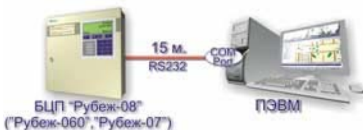
Рис. 85 Схема подключения БЦП к ПЭВМ через СОМ порт
