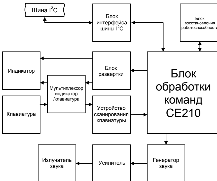
Рис. 4 Схема электрическая функциональная устройства управления и индикации
