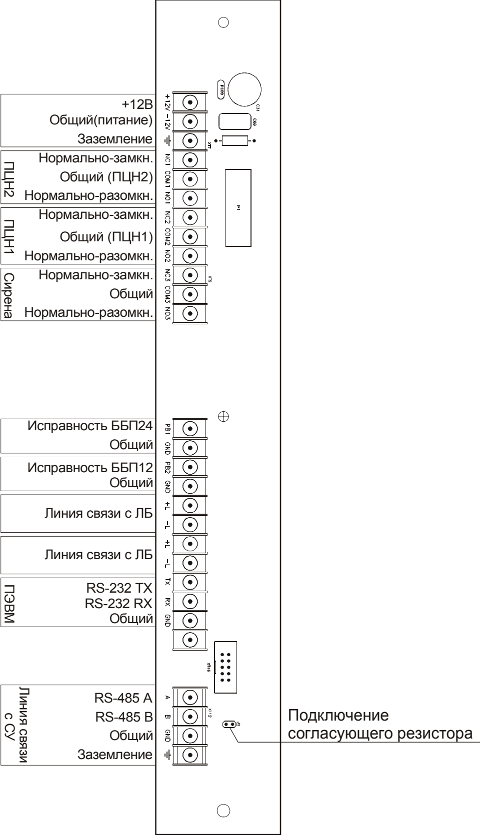
Рис. 8 Схема подключения БЦП
