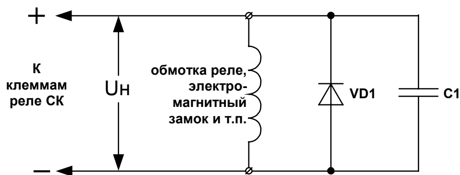
Рис. 5 Схема электрическая принципиальная шунтирующей цепи при подключении индуктивной нагрузки к клеммам реле СК
