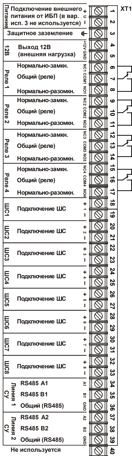
Рис. 17 Схема подключения БЦП (исп. 1,2)
