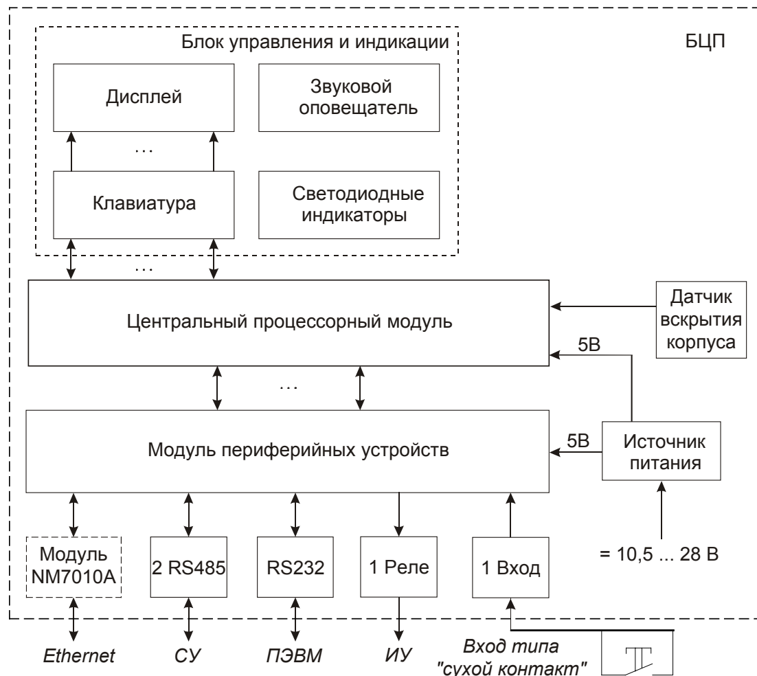
Рис. 6 Электрическая структурная схема БЦП Рубеж-08 исп. 6
