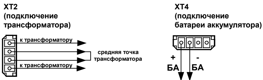
Рис. 23 Разъемы XT2 и XT4 исп. 3
