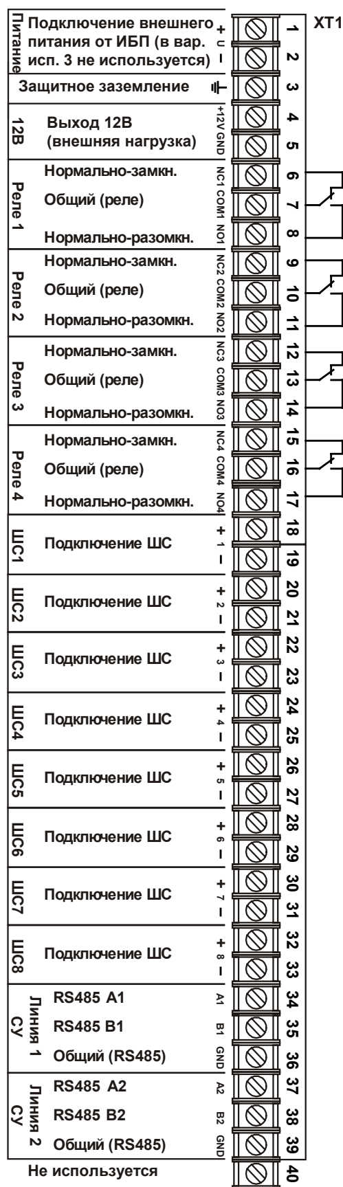
Рис. 9 Схема подключения БЦП (исп. 1,2)
