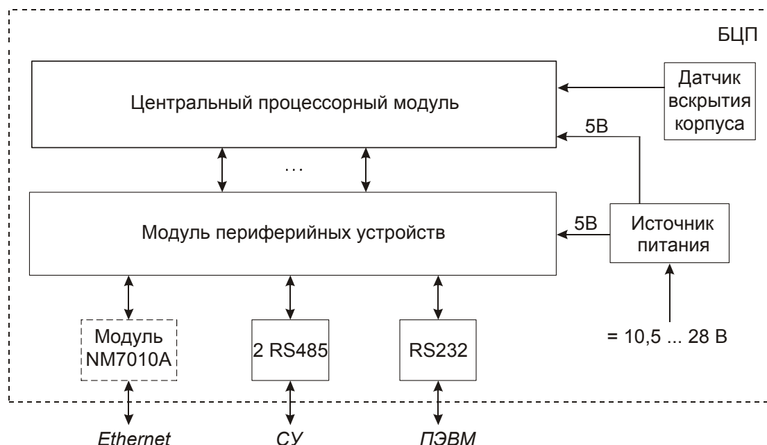
Рис. 5 Электрическая структурная схема БЦП Рубеж-08 исп. 5
