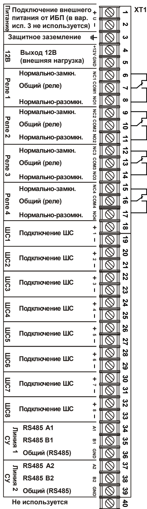
Рис. 15 Схема подключения БЦП (исп. 1,2)
