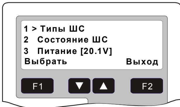
Рис. 21 Проверка монитора питания СКШС
