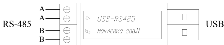
Рисунок 1 Схема подключения «USB-RS485»
