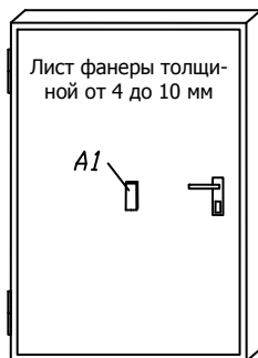
Рисунок 7 Защита деревянной пустотелой двери
