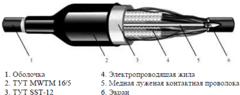
Рис. В.1 – Конструкция линейной части ЧЭ
