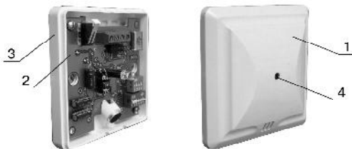
Рисунок 46. Конструкция извещателя
