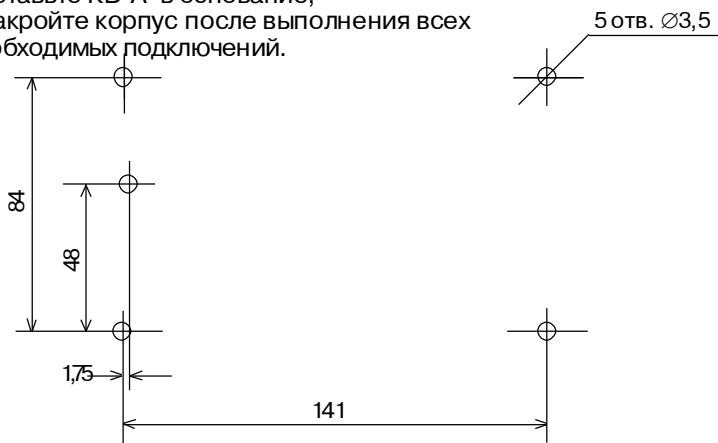
Рисунок 12. Схема разметки для установки клавиатуры КВ-А
