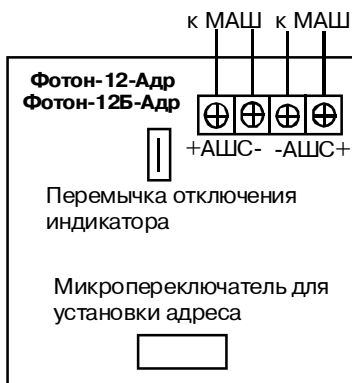
Рисунок 23. Схема внешних подключений извещателя
