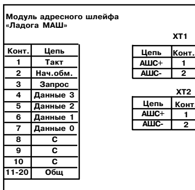
Рис. 6 Схема электрическая общая МАШ
