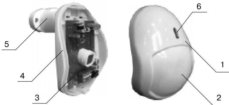
Рис.23 Конструкция ИК-А
