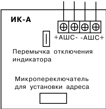
Рис. 25 Схема внешних подключений ИК-А
