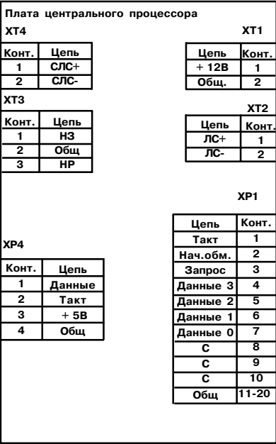
Рис. 2. Схема электрическая общая БЦ-А
