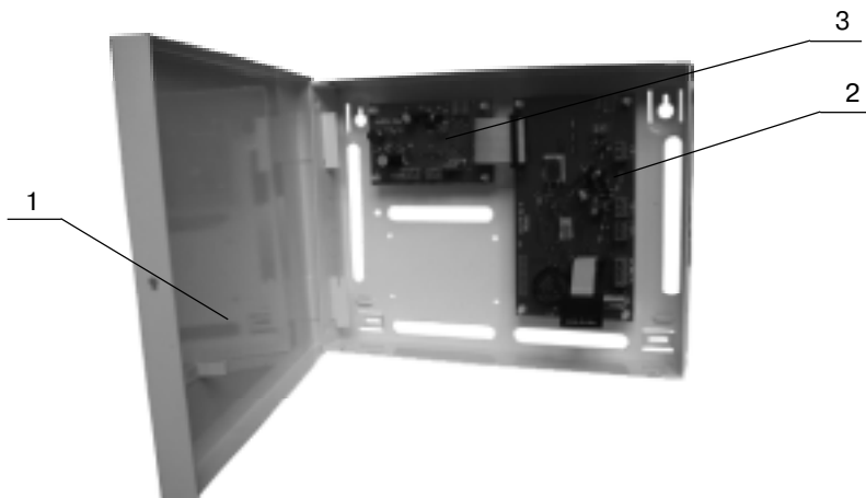
Рис. 3. Конструкция БЦ-А
