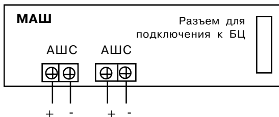
Рис. 8 Схема внешних подключений МАШ
