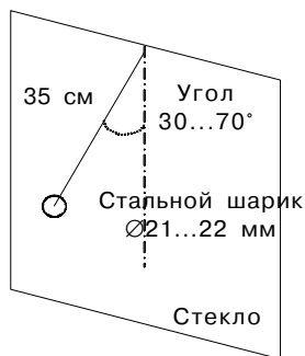
Рис. 34 Нанесение имитационного удара по стеклу при настройке извещателя
