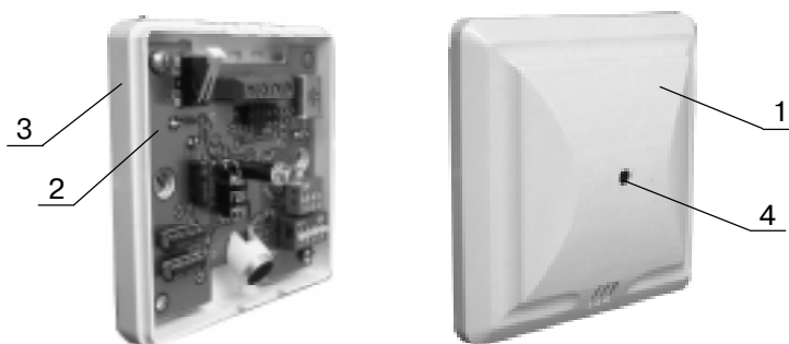
Рис. 28 Конструкция 3В-А
