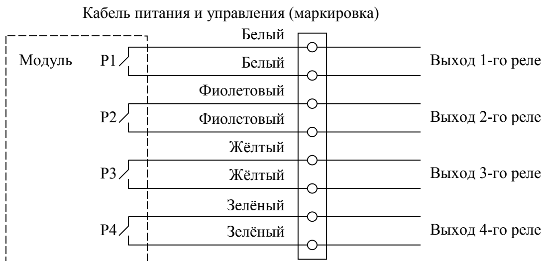
Рис. 8.6. Подключение выходных реле.
