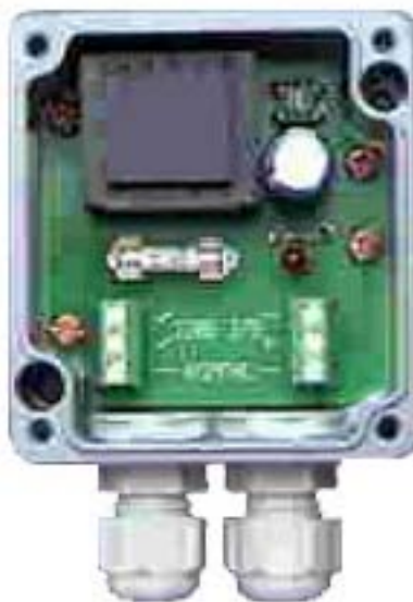
Рис. 8.2. Внешний вид блока питания со снятой крышкой.
