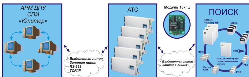
Рис.2 Передача извещений на пульт охраны по локальной сети или другому цифровому каналу в протоколе TCP/IP.
