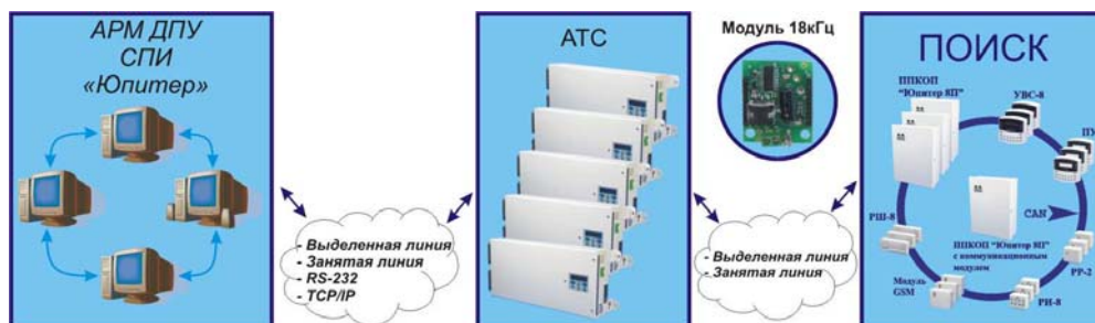
Рис.3 Передача извещений на пульт охраны по занятой телефонной линии на частоте 18 кГц.
