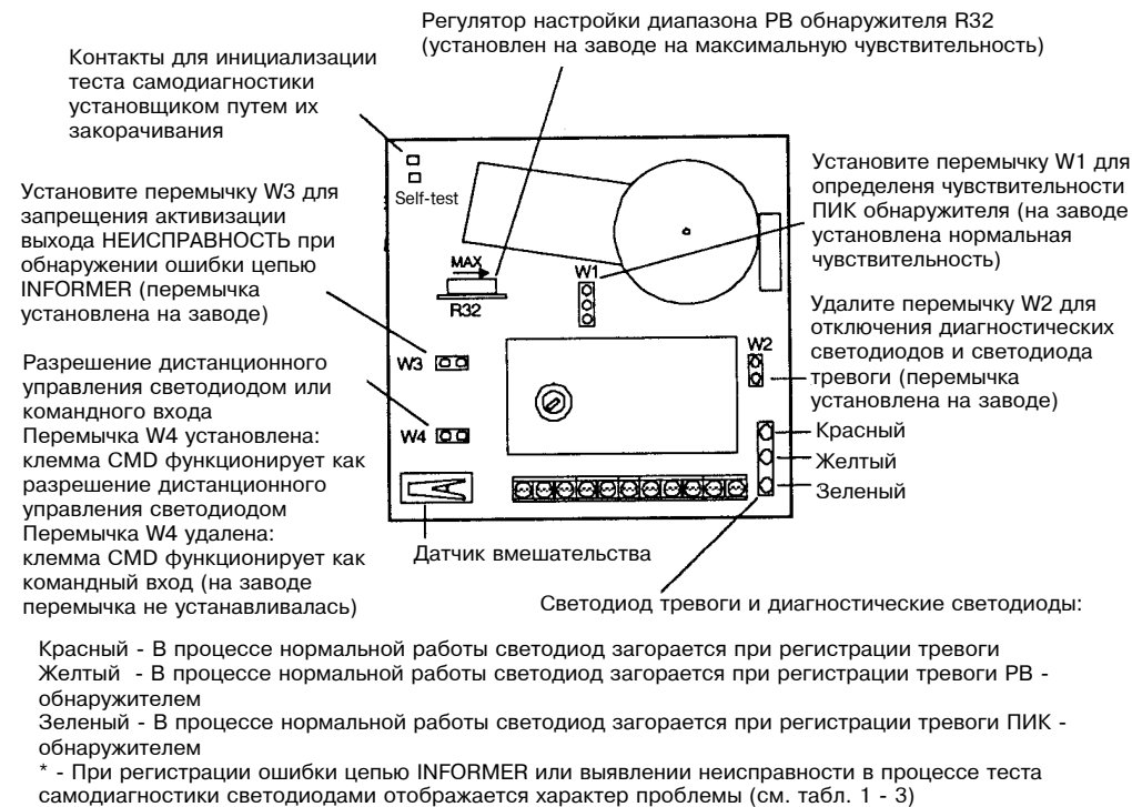
Рис. 5 Внешний вид печатной платы DT-6360STC
