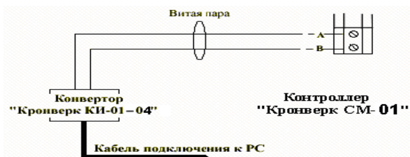
Рис. 3.а. Подключение одного контроллера «Кронверк СМ-01».
