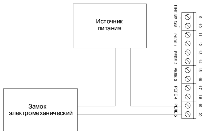
Рис. 9 – Схема подключения электрозамка
