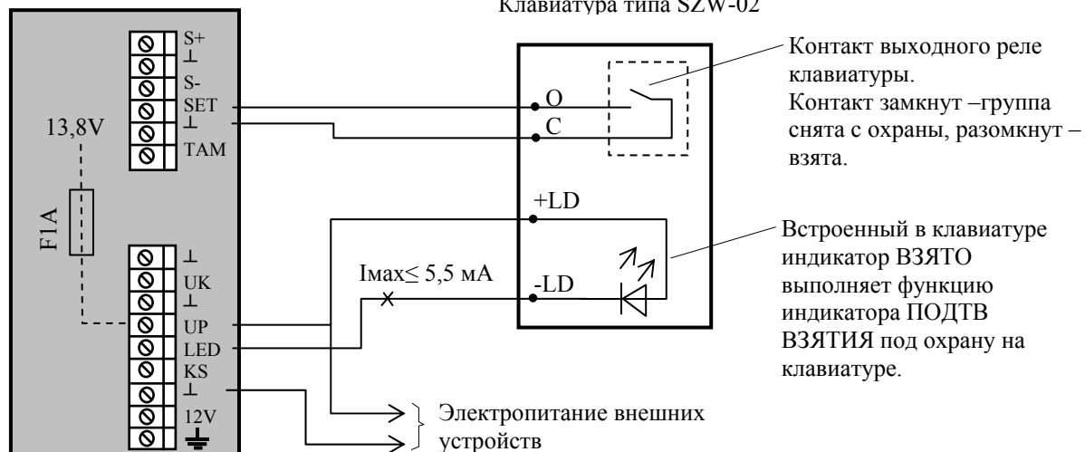
Рисунок Г.6 - Пример подключения к ППК клавиатур с выходным реле
