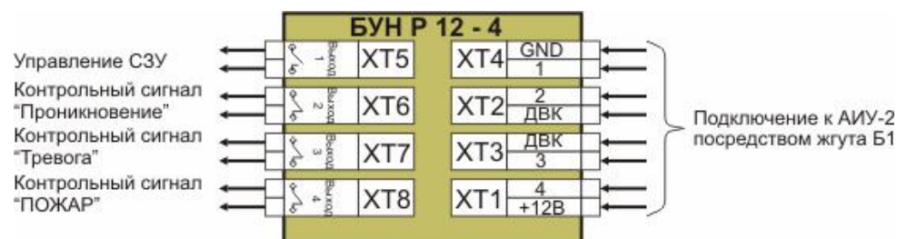
Рисунок 30. Подключение БУН Р12-4.
