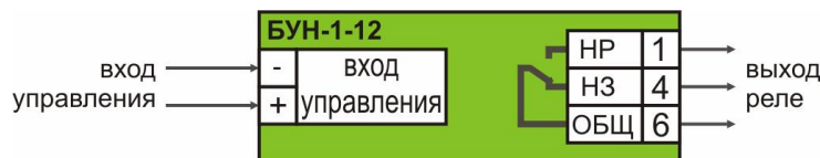
Рисунок 29. Подключение БУН 1-12.
