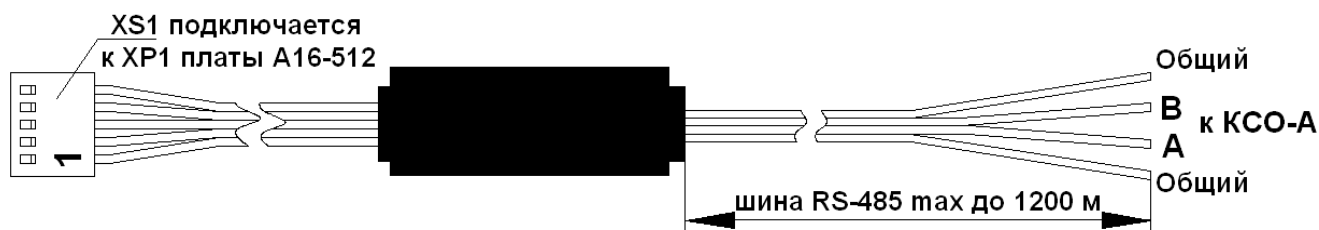
Рисунок 15 – Внешний вид модуля интерфейса ИС-485
