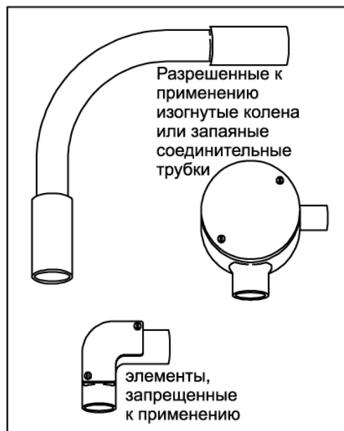
Рис. 29. Переходники для защиты кабеля в местах изгиба.
