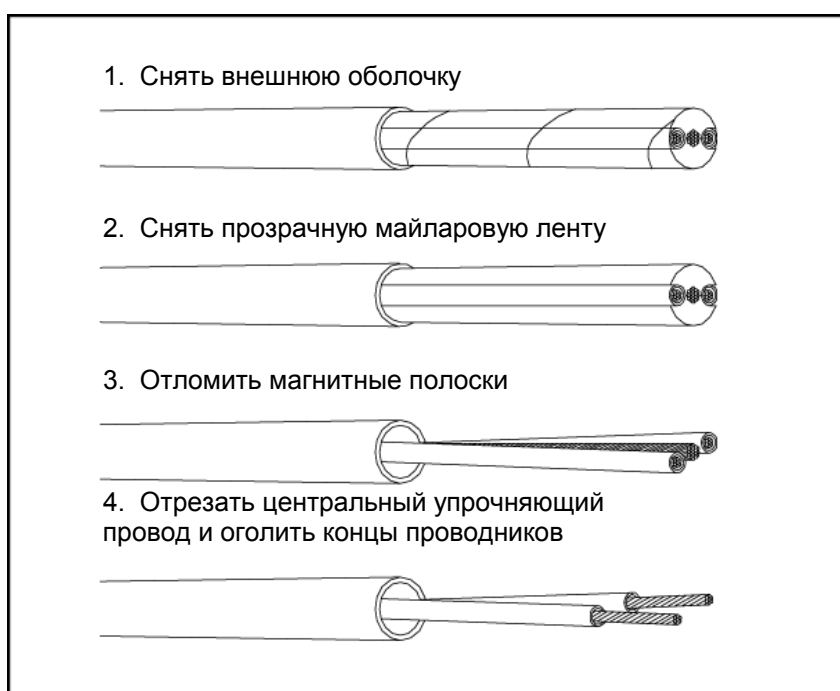
Рис. 31. Подготовка сенсорного кабеля к подключению.
