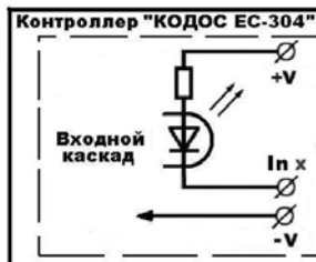
Рисунок 6 – Схема входных каскадов «In x»
