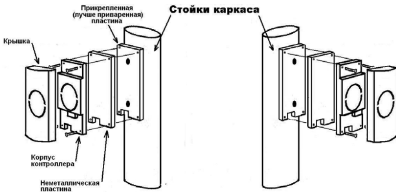
Рисунок 20 – Установка контроллера на общий каркас
