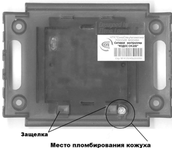
Рисунок 6 – Вид обратной стороны корпуса сетевого контроллера
