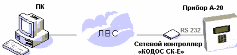
в – Схема подключения одного прибора А-20 к ПК по ЛВС
